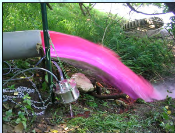
Installation du fluorimètre en continu en sortie de pompage - Cliché Calligée
