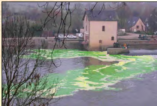
Injection de traceur à partir d'une berge - Cliché Calligée
