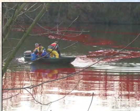
Injection de traceur au fil de l'eau - Cliché Calligée
