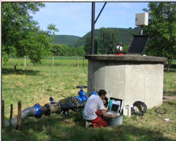
Essai de pompage - Captage AEP du Roc (46) - Cliché Calligée
